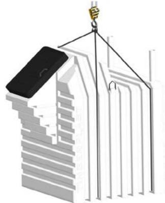
4.1.3. Запрещается стропить погреб за внутренние конструкции (каркас, лестницу) и горловину.
