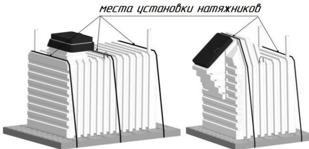
**ВНИМАНИЕ:** для предотвращения повреждения погребя, не допускается спуск скрепленных вместе погребя и плиты-якоря в котлован одновременно.
